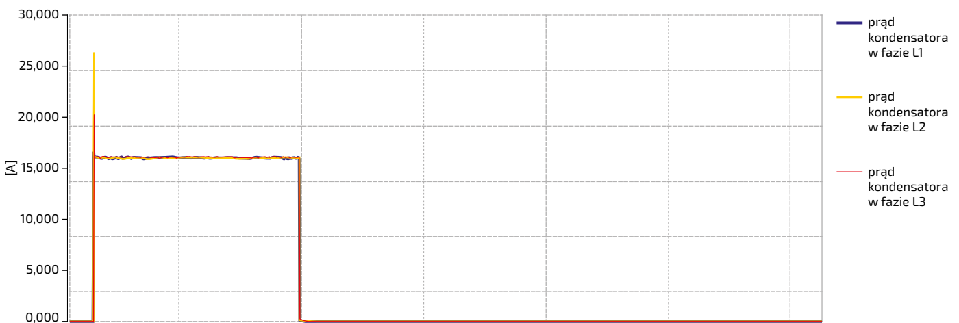
Przebieg RMS 10 ms załączenia rozładowanego kondensatora poprzez stycznik
