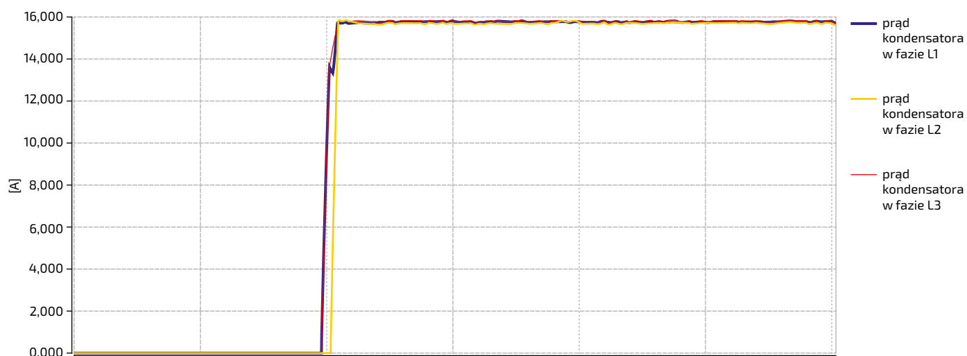
Przebieg RMS 10 ms załączenia rozładowanego kondensatora poprzez łącznik LH
